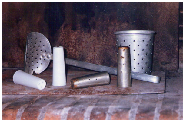
Fig. 2: Moules "étuis" et écumoire de moulage.
