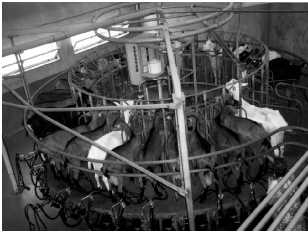
Le manège de traite avec un trayeur extérieur permet une meilleur cadence de traite pour les grands troupeaux.
