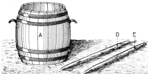
FIG. 60. — Pour transporter de petites quantités de ce liquide, on se sert de la tine A, avec brancards mobiles D, E.
